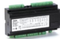
C'est le régulateur où il y a le plus de relais, mais aussi il permet la gestion de la HP flottante. Comme nos besoins sont de quinze relais, et que ce régulateur n'en dispose que de huit. Nous allons ajouter des modules supplémentaires avec la sélection de 2 régulateurs EKC 331T pour atteindre le nombre de relais voulus.
