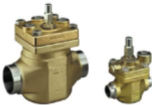
Les vannes ICS1 ICS3 sont des vannes pilotées qui peuvent assurer de nombreuses fonctions nécessaires au fonctionnement d'une installation frigorifique. La fonction est définie par le ou les pilotes qui sont à assembler sur le corps de vanne. Les vannes ICS 1 peuvent recevoir 1 pilote et des vannes ICS 3 peuvent recevoir 2 ou 3 pilotes. Plage de température de -60°C à +120°C. Pression maximum de service 52 Bar. Raccordements à braser en pouces (modèles avec raccords DIN sur demande).
