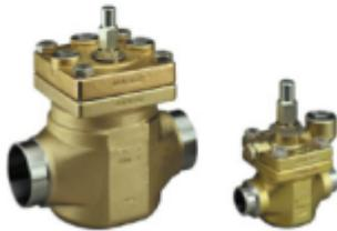
Les vannes ICS1 ICS3 sont des vannes pilotées qui peuvent assurer de nombreuses fonctions nécessaires au fonctionnement d'une installation frigorifique. La fonction est définie par le ou les pilotes qui sont à assembler sur le corps de vanne. Les vannes ICS 1 peuvent recevoir 1 pilote et des vannes ICS 3 peuvent recevoir 2 ou 3 pilotes. Plage de température de -60°C à +120°C. Pression maximum de service 52 Bar. Raccordements à braser en pouces (modèles avec raccords DIN sur demande).
